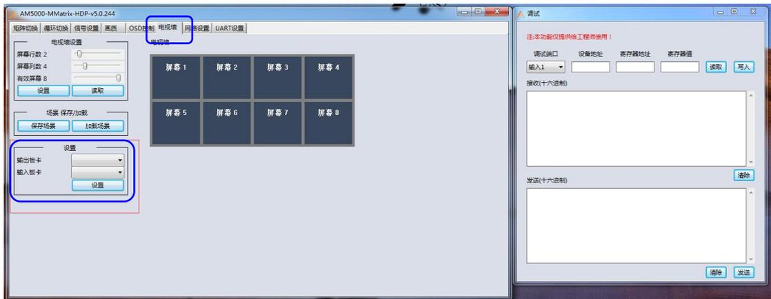
根据实际的输入输出通道数在红色框住的地方设置输入输出板卡通道。
